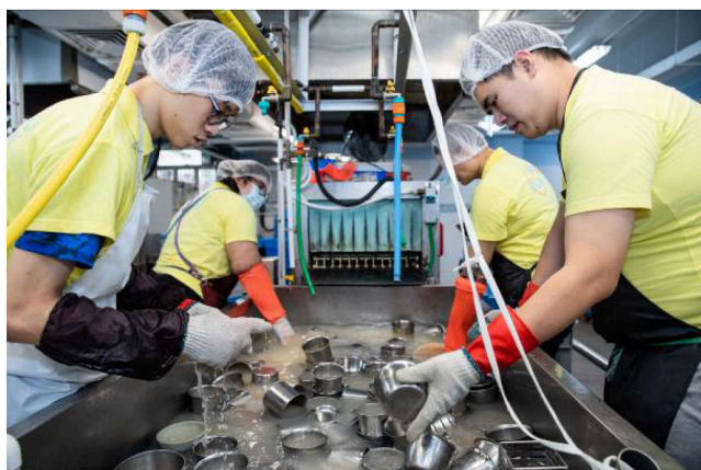
■ 除渣機有效清除餐具上九成食物殘渣，節省了不少往後步驟的能源耗用。
