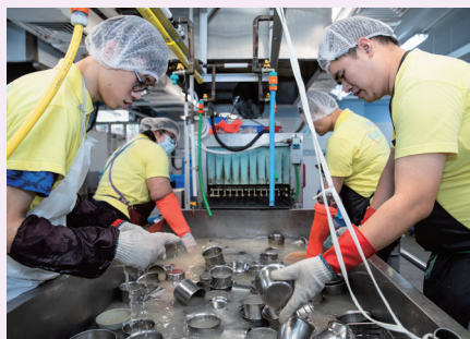
▲除渣機有效清除餐具上九成食物殘渣，節省了不少往後步驟的能源耗用。
