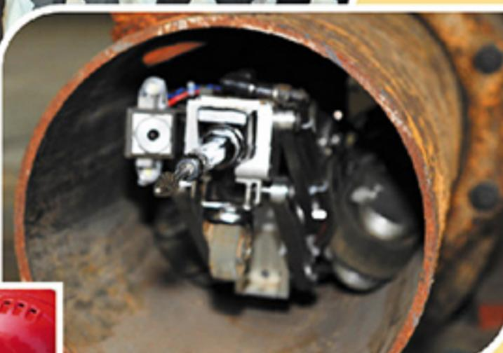
▲ Laparobot附有錄像鏡頭，可配備紅外線熱像儀、利刀或鋼鉗等工具，以便在管內進行不同的工作，如測漏、鑽孔、切割等。
